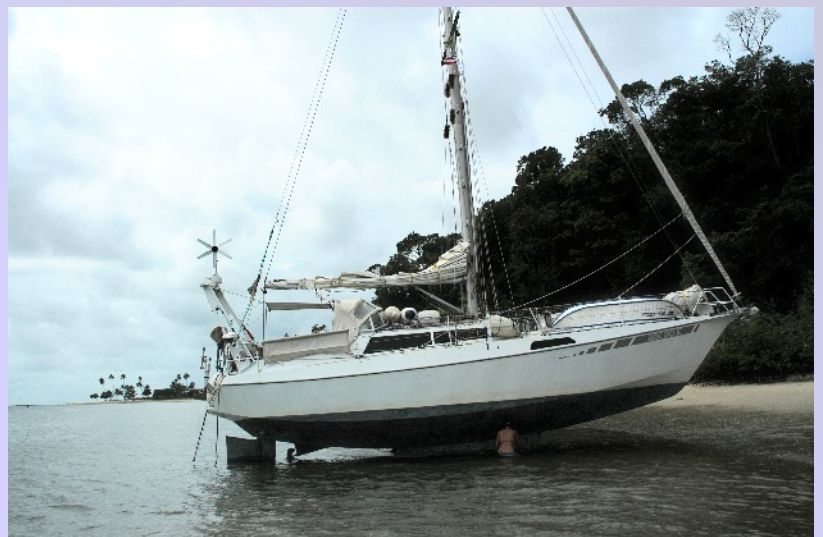
JUST DO IT ibei Tororo (Bahia de Todos os Santos, bei Salvador, Brasilien) auf den Strand gesetzt, um das Unterwasserschiff zu reinigen.
