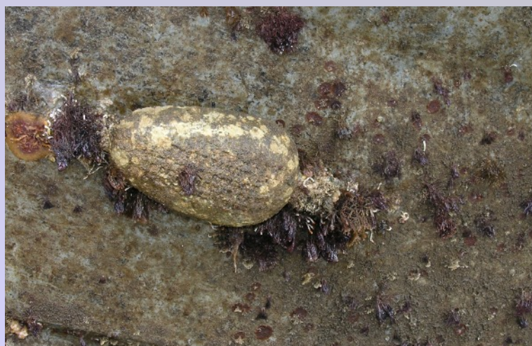
Opferanode am Rumpf. Der dunkle Bewuchs unterhalb der Anode sind Babyentenmuscheln. In Brasilien hatten sie uns schließlich doch erwischt.
