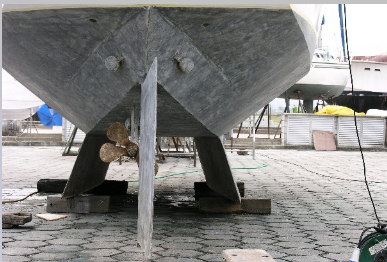
JUST DO IT nachdem der Unterwasseranstrich mit Edelstahltopfbürste und Winkelschleifer frisch abgebürstet wurde. Ob zur Aktivierung oder als Vorbereitung für einen neuen Anstrich, das Ergebnis sieht stets gleich aus. Auch gut zu sehen: Die Welle mit dem Autoprop kann wegen der versetzten Anordnung von Wellenhose und Stevenrohr problemlos am Ruder vorbei gezogen werden.
