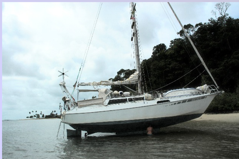
JUST DO IT ibei Tororo (Bahia de Todos os Santos, bei Salvador, Brasilien) auf den Strand gesetzt, um das Unterwasserschiff zu reinigen.
