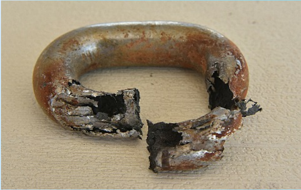
Abb. 6: Ein Ankerkettenglied, mehr oder weniger aufgelöst.
