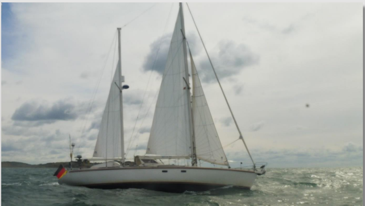
MAGO DEL SUR im August 2018 etwas unscharf bei rauer See auf der Ostsee. Nicht ganz einfach zu erkennen: Das Groß ist um eine Latte und der Besan um zwei Latten eingerefft. (Foto: Manfred, SY FATU IVA)
