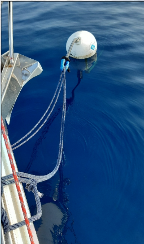
Eine sehr ordentliche Muring. Sogar mit einem leinenschonenden Überzug an der Schlaufe. Wir hängen zur Sicherheit an zwei Leinen.
