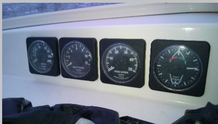
Erstbesichtigung der damaligen BRONWYN 2016: Die gesamte alte Elektronik stammte überwiegend von B&G und war in die Jahre gekommen. Heute weitgehend erneuert und von Furuno.
