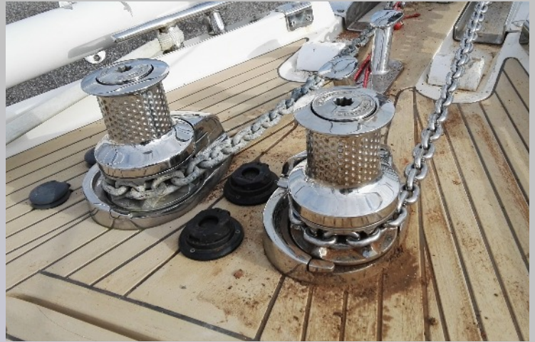
Vorbereitungen für die Überführung: von MAGO Beide Ketten sind im Prinzip vertretbar. An Backbord eine verzinkte Kette, an steuerbord eine von uns mitgebrachte Duplex-Kette. Wegen des schlechten Zustands trauten wir den vorhandenen Ketten nicht. Und einen vernünftigen Bügel-Anker hatten wir vorsichtshalber auch mitgebracht. Der Dreck ist übrigens Rost von der losgeklopften alten Kette an Steuerbord (kein Amel Original). Wir wissen nicht, was der Voreigner hier getrieben hat.)
